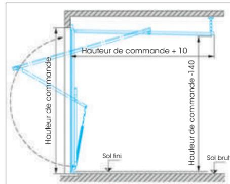
La pose d'un automatisme Novomatic® nécessite une retombée de linteau supplémentaire de 40 mm.
