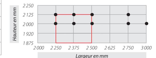
La porte OD-IL se fabrique sur-mesure en largeur uniquement : de 2000 à 2625 mm. Hauteurs disponibles : 1920 ; 2000 et 2125 mm.
