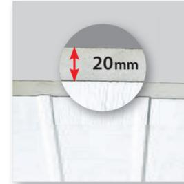
Les panneaux verticaux de **Noviso®** sont constitués d'un sandwich de 20 mm de mousse polyuréthane injectée, entre deux tôles d'acier galvanisé et prélaqué. Ils bénéficient d'un faible coefficient de transmission thermique (1 W/m²K) et donc d'une bonne isolation.
